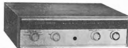
Fig. 1. - Amplificatore stereo a transistori Mod. AA-14E, Heathkit.
